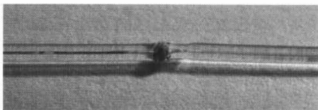
写真4 多量の気体発生により爆発し、ヒューズ伝搬が停止した様子
